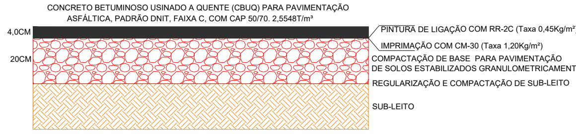
DETALHAMENTO DO PERFIL DO PAVIMENTO COM CBUQ Sem Escala
