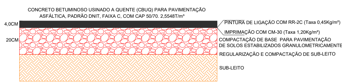
DETALHAMENTO DO PERFIL DO PAVIMENTO COM CBUQ Sem Escala
